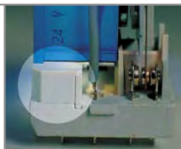
B: Tipul contactului 5, 6 Separator fizic între bobină și contacte (pentru aplicații SELV)
